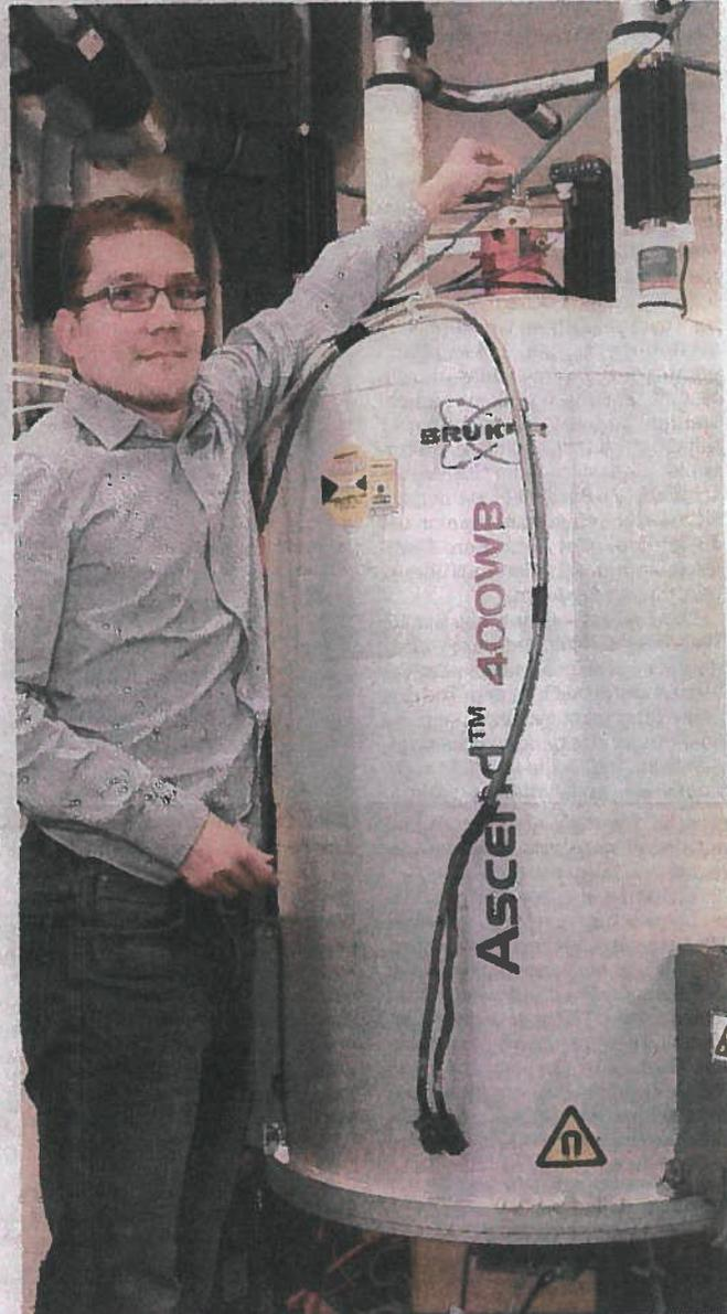
Alexander Wulf setzt eine Probe in das Festkörper-NMR-Spektrometer. In den kommenden Wochen wird er sich in alle Gerätfunktionen einarbeiten.
